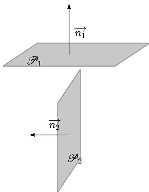
*Les vecteurs normaux sont orthogonaux et les plans sont perpendiculaires*
